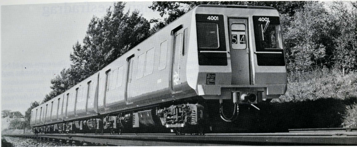
BR's nyeste materiel (her prototype) til nyligt elektrificerede forstadsruter har automatisk vognkobling, som kan klares fra førerkabinen.
